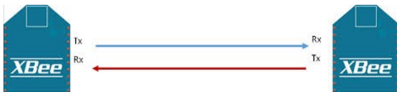
Рис.3. Конфигурация Xbee устройств
