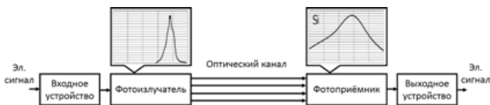
Рисунок 1. Обобщённая структура оптической системы передачи электрического сигнала
