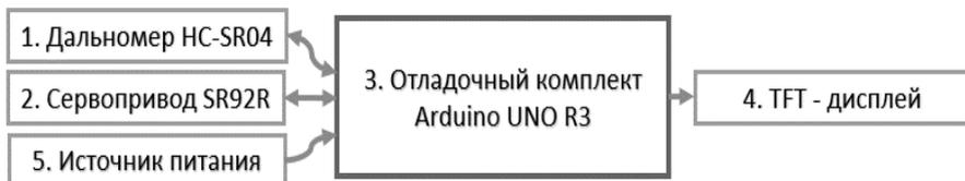
Рисунок 1 – Структурная схема макета
