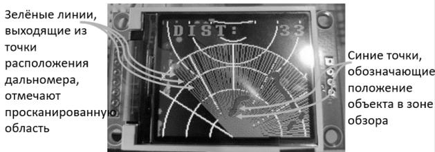
Рисунок 2 – Экран, отображающий графическую информацию о положении объектов в зоне видимости радара относительно координат дальномера на местности
