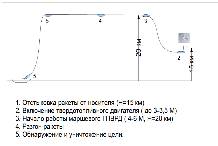
Рис.2. Оптимальная траектория гиперзвуковой противокорабельной крылатой ракеты
